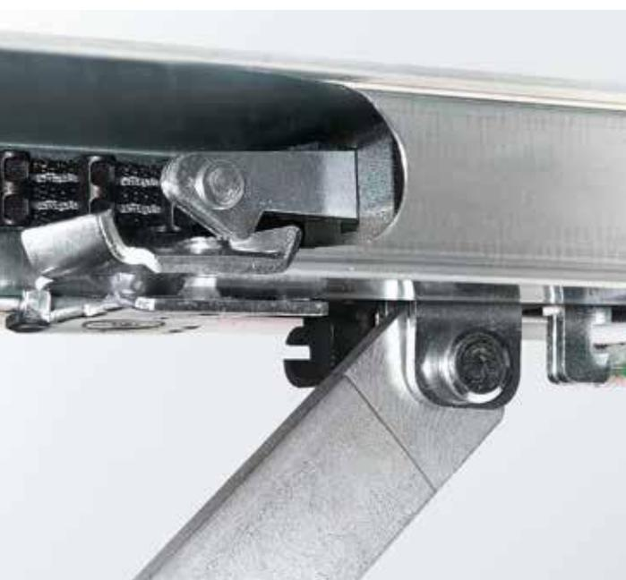
**SÛRE.** Lorsque la porte de garage est fermée, la sécurité antirelevage s'encliquette automatiquement dans la butée du rail de guidage. La porte se verrouille immédiatement et est ainsi protégée contre toute effraction au pied-de-biche. En outre, deux crochets situés sur le côté de la porte relient solidement l'extrémité du tablier de porte et le montant latéral.
