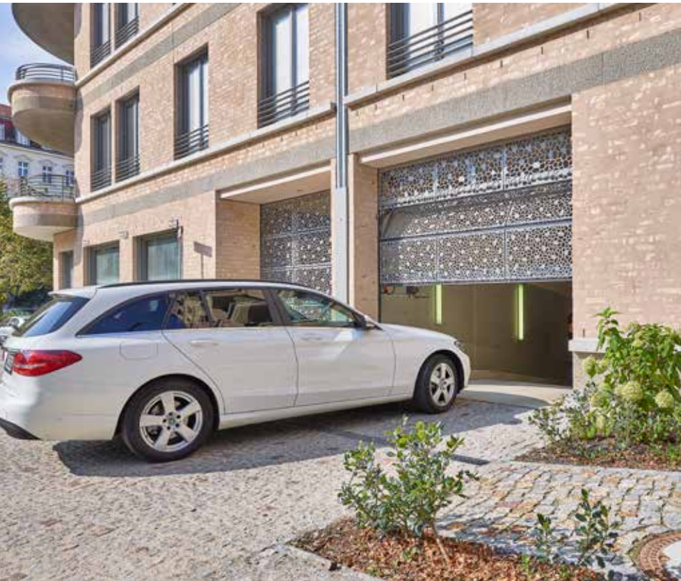
EN HAUT A GAUCHE. ALR F42 avec remplissage par grille fourni par l'utilisateur
